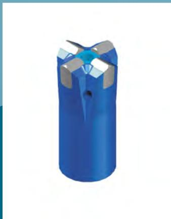
Крестовые буровые коронки типа БКПМ-КМ с конусным соединением со штангой. Диаметр 32, 34, 36, 40 и 43 мм. Предназначены для бурения трещиноватых горных пород средней крепости и крепких пород переносными перфораторами.
