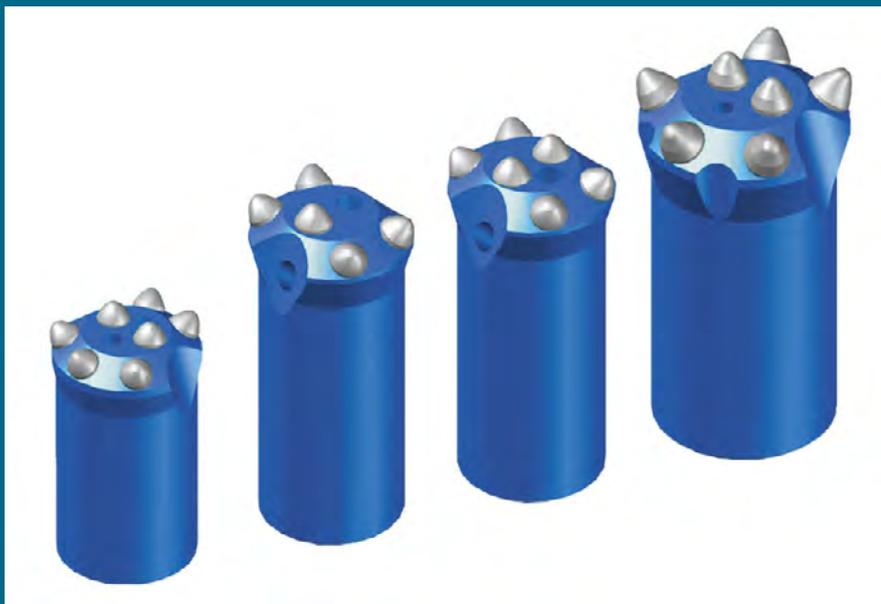
Штыревые коронки типа КНШ с конусным соединением со штангой. Диаметр 28, 30, 31, 32, 34, 36, 38, 40 и 43 мм. Предназначены для бурения шпуров в горных породах средней крепости, крепких, крепчайших монолитных и среднетрециноватых, средней абразивности переносными перфораторами.
