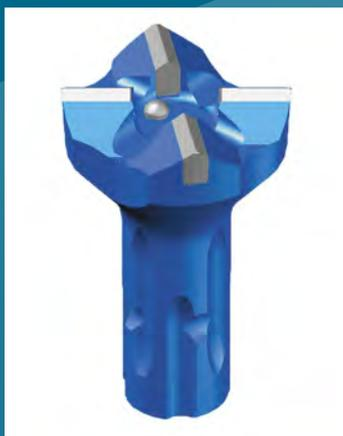
Буровые коронки типа К для бурения погружными пневмударниками с байонетным соединением. Диаметр 110 и 130 мм. Предназначены для бурения взрывных скважин в горных породах средней крепости.
