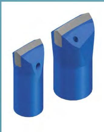
Долотчатые буровые коронки типа БКПМ с конусным соединением со штангой. Диаметр 28, 32, 34, 36, 40 и 43 мм. Предназначены для бурения крепких монолитных горных пород переносными перфораторами.
