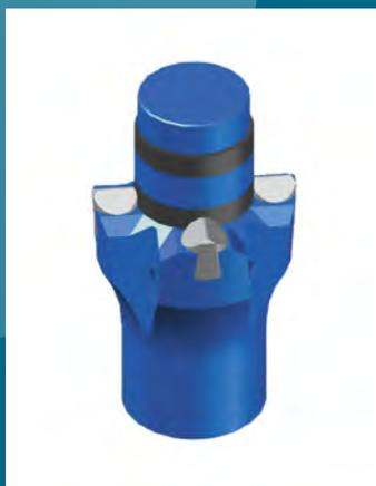
Крестовые коронки-расширители типа КРР с конусным и КРК с резьбовым соединением со штангой. Диаметр 65 и 105 мм. Предназначены для бурения компенсационных скважин в параллельных врубах переносными перфораторами.
