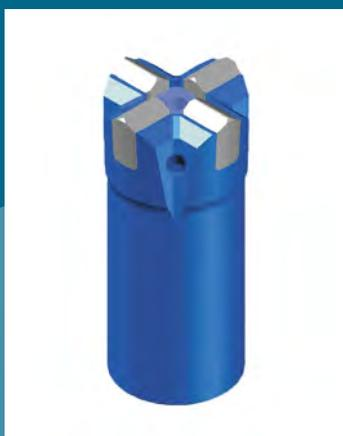
Крестовые буровые коронки типа БКР с резьбовым соединением со штангой. Диаметр 43, 45 и 50 мм. Предназначены для бурения монолитных и трещиноватых горных пород средней крепости колонковыми перфораторами.
