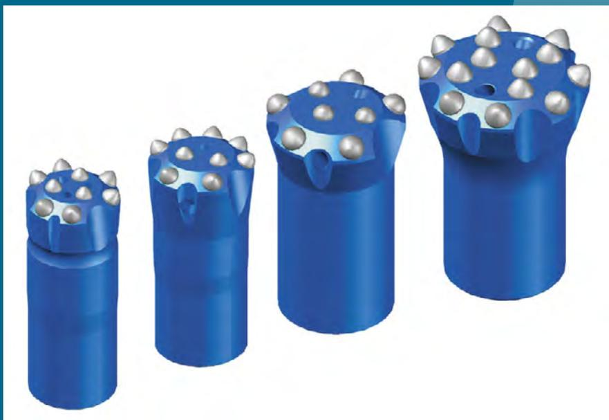
Штыревые коронки типа КНШ с резьбовым соединением со штангой. Диаметр 43, 45, 51, 55, 57, 65 и 76 мм. Предназначены для бурения шпуров и скважин в крепких и крепчайших монолитных и среднетрециноватых горных породах средней абразивности колонковыми перфораторами.
