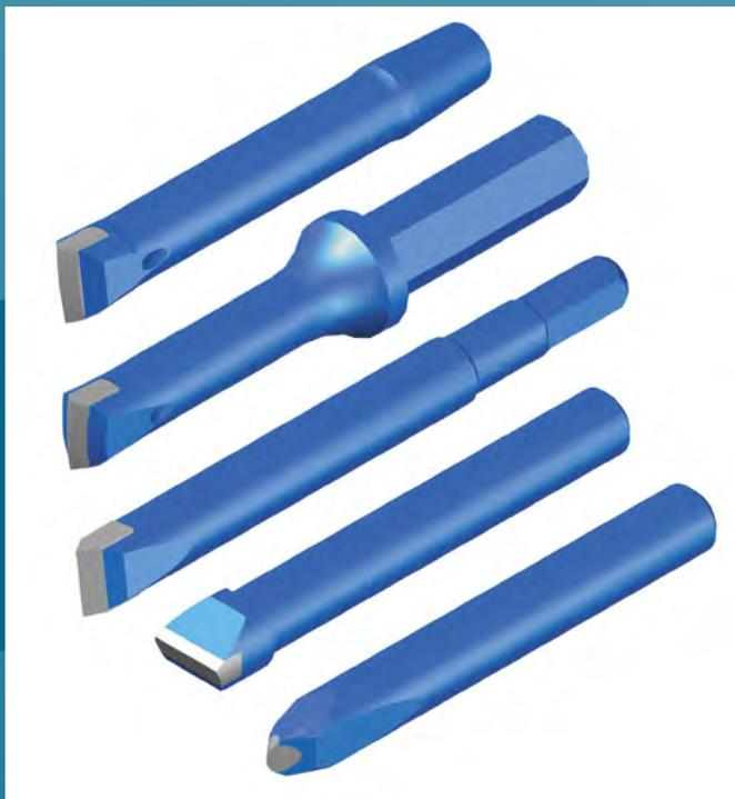
Буры типа БТ и БТШ, скарпели типа СТР и СТМ, закольники типа ЗТР, шпунты типа ШТР и ШТМ. Предназначены для бурения шпуров, черновой обработки изделий из гранита, чистовой тески фасок и лент облицовочных изделий из камня.
