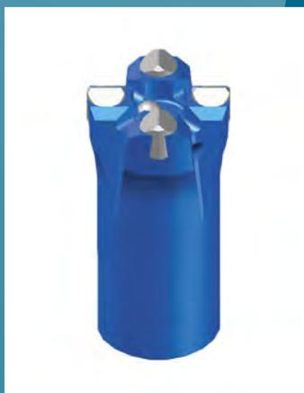
Комбинированные буровые коронки типа БКРШ-К с резьбовым соединением со штангой. Диаметр 51 и 56 мм. Предназначены для бурения особо крепких, хрупких горных пород колонковыми перфораторами.
