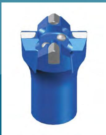
Комбинированные буровые коронки типа БКР-К с резьбовым соединением со штангой. Диаметр 55, 60, 65 и 70 мм. Предназначены для бурения особо крепких, хрупких горных пород колонковыми перфораторами.
